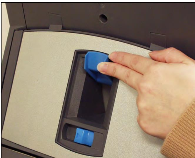
Figure 3.8.1 : Poussez le levier de l'écart de séparation
