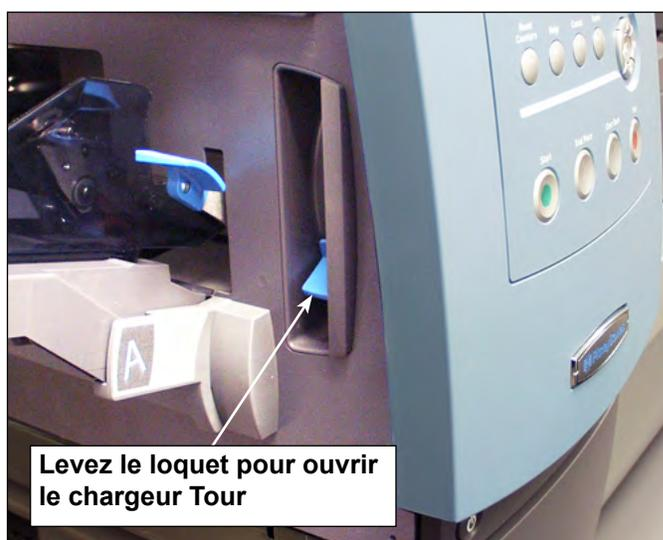
Figure 2.2.1 : Loquet d'ouverture du chargeur Tour.
