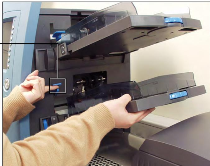
**Figure 3.1.1** : Soulevez le séparateur et faites glisser le plateau dans ses supports.
