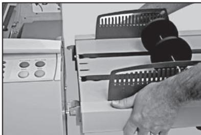
Elle est fixée à la machine à l'aide de deux crochets glissés dans les ouvertures au niveau de la sortie de la plieuse.
