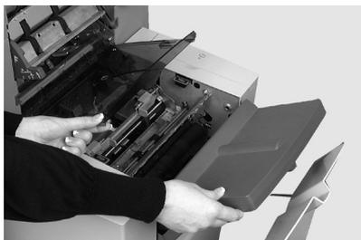
3. Pressez les deux onglets bleus (A) et soulevez un onglet (A) pour accéder aux feutres du dispositif de collage.
