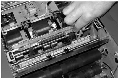
9. Poussez la languette bleue pour remettre l'ensemble du feutre supérieur en position de fonctionnement. Assurez-vous que les loquets bleus (A) ressortent et se verrouillent complètement en position.
