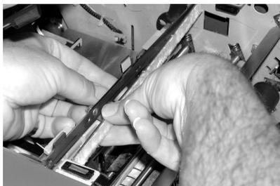
8. Installez les quatre nouveaux feutres dans le réservoir de collage. Ils ne peuvent être installés que dans une seule direction. Rabaissez-les entièrement dans le réservoir.
