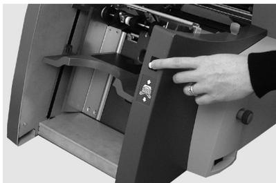
2. Utilisez la molette de réglage des guides latéraux pour ajuster ces derniers à la largeur des enveloppes. Une fois ajustés, retournez la molette de réglage d'un quart de tour.
