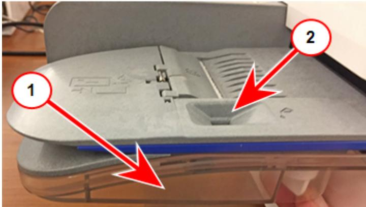
2. Fügen Sie genügend Schließflüssigkeit hinzu, um die Schließflüssigkeit bis zum unteren Rand der Einfüllöffnung zu bringen **(2)**. Überfüllen Sie den Tank nicht.
