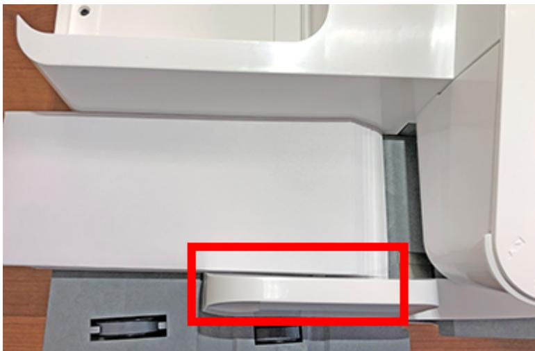
4. Poussez la pile dans l'alimenteur jusqu'à ce que vous sentiez une résistance. L'image indique à quelle distance dans le chargeur vous devez positionner la pile. Le guide latéral est tiré pour montrer le bord des enveloppes.
